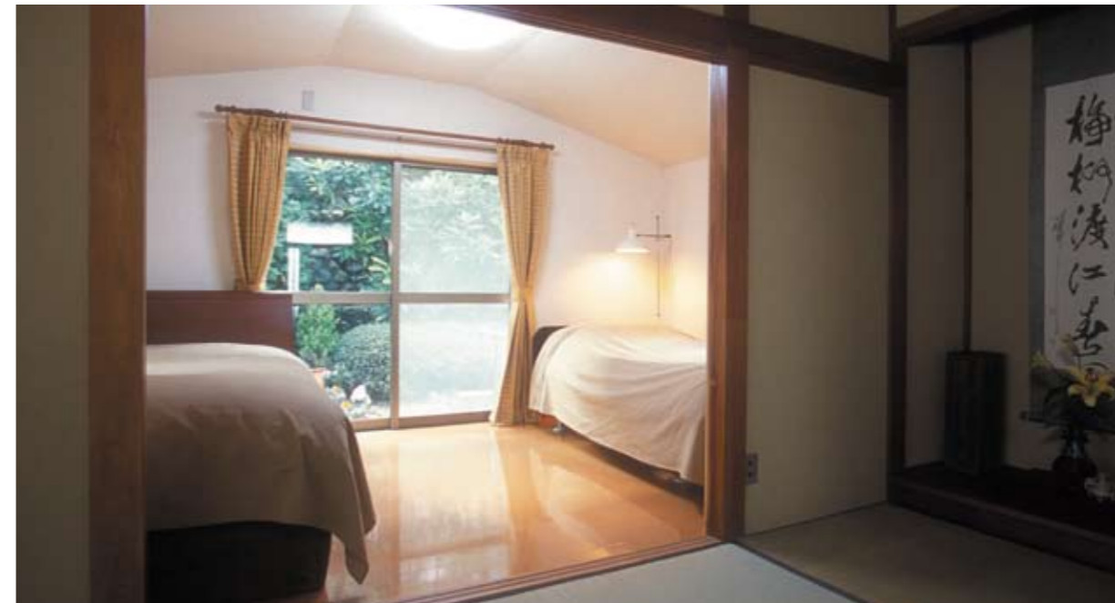
和室の雰囲気を損なわないように床は縁甲板、クロスは和室と違和感のない和紙風クロスを使用
