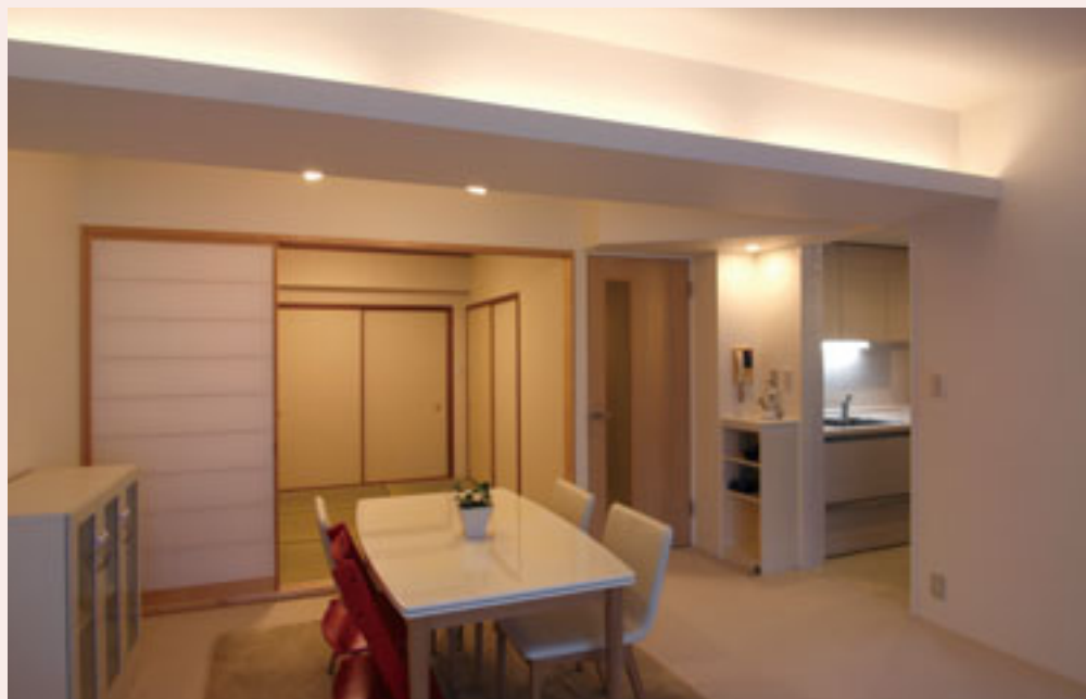
梁を照明に利用しました。リビング側には部屋の主照明にもなりえる間接照明を設置しました。
