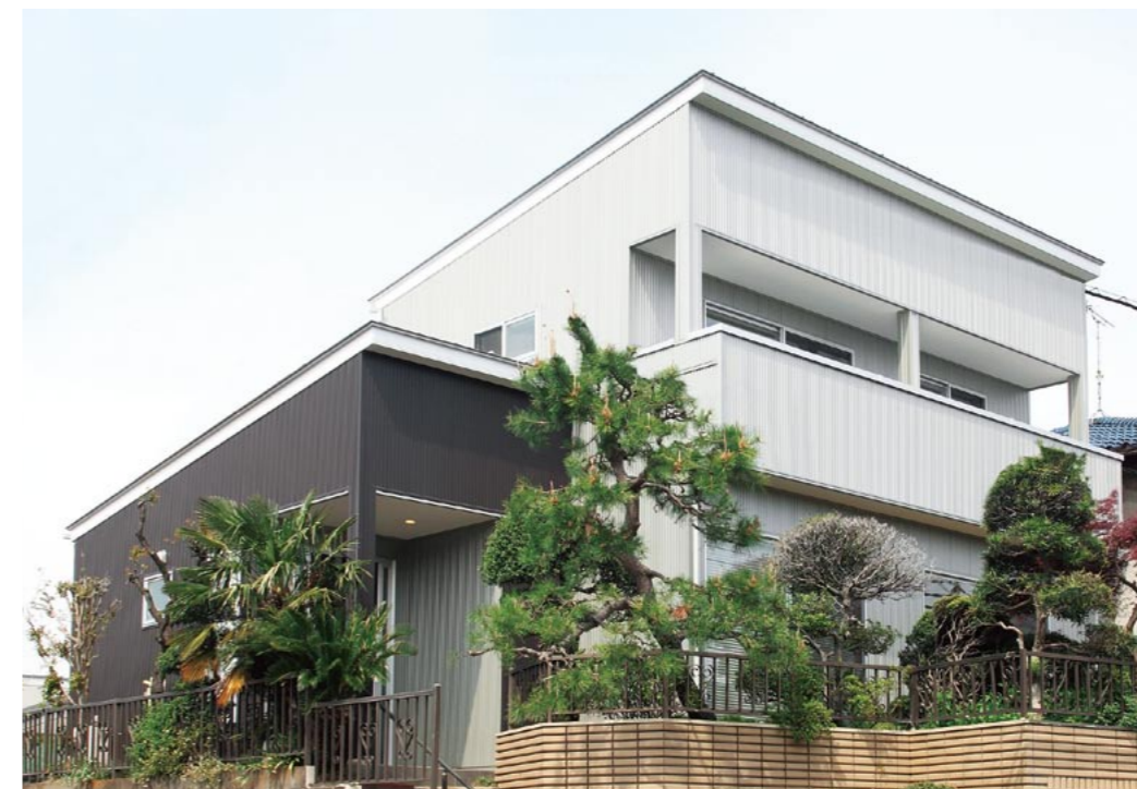
シルバーとビターブラウンのツートンの縦張りサイディングで、シャープな外観に。
